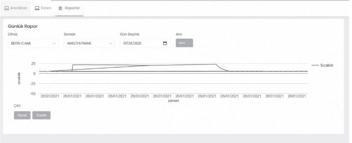
Figür 4: Merkezi Isı Takip Sistemi Klinik Kan Dolabı Isı Yükselmesi Trase Veri Ekran Örneği
